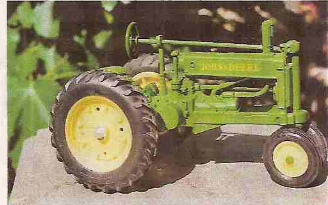
John Deere Schlepper Modell „A“ mit liegendem Zweizylinder Motor wurde von 1932 bis 1938 gebaut. Er hatte eine Leistung von 30 PS bei 975 U/min.
