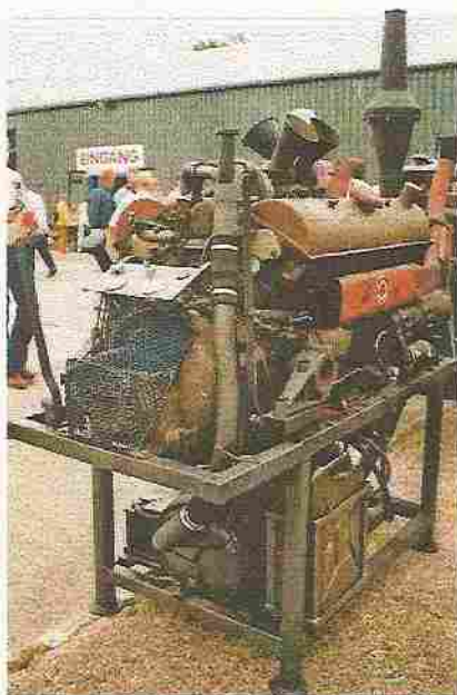
Ein interessanter Motor, allerdings kein Stationär-Motor, war der wassergekühlte V 12 Zylinder Maybach Benzinmotor mit einem Hubraum von 24.000 ccm und einer Leistung von 700 PS, Baujahr 1942. Der Motor war im Tigerpanzer und im Zeppelin eingebaut.
