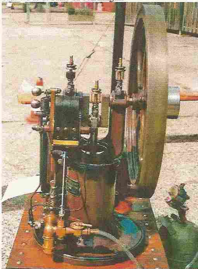
Der wassergekühlte Viertaktmotor Typ Germanus A1,
