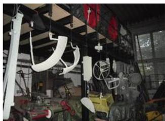
Der Eicher wurde in **alle** Einzelteile zerlegt, das könnt ihr wörtlich nehmen. Jedes Einzelteil wurde auf Neuzustand aufgearbeitet, grundiert und zum Trocknen aufgehängt. Jetzt beginnen die ersten zaghaften Montageversuche mit neuen Lagern, Dichtungen und Kleinteilen. Man arbeitet
