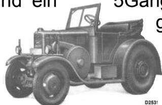
geschaltet wurde. Der Heck-Kraftstofftank fasste 200L. Die Höchst-geschwindigkeit betrug 33km/h, das Gewicht der betriebsbereiten Maschine betrug 4500kg.
