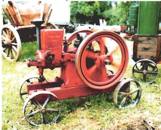
Dieser schöne und interessante Stationärmotor mit dem Namen HIRED MAN (zu deutsch Tagelöhner) wurde 1920 von der Firma Associated Manufacturers Company, kurz Amanco, in Waterloo Iowa gebaut.
