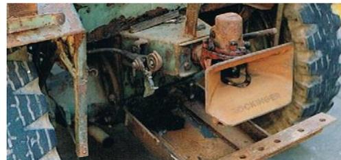
Laut Fahrzeugbrief wurde 1960 eine Einkreis-Druckluftanlage für Anhängerbetrieb und eine Rockinger-Anhängerkupplung angebaut.
