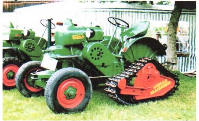
Die Allgaier Schlepper R18, links im Bild und A22 rechts gehören mit zu den bekanntesten Vertretern der Schlepper deren Motoren durch die Verdampfung von Wasser gekühlt werden.
