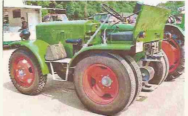
Bei der hier vorgestellten Maschine mit Zwillingbereifung 7.50-20 und Sitzbank handelt es sich um eine Straßenzugmaschine für den Nahverkehr. Im „Traktor Oldtimer Katalog“ wird dieser Schlepper mit 20.000 Euro bewertet.
