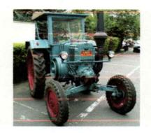
Typen. Sie hatten große Räder mit der Bereifung 8.00-36 mit Speichenrädern und eine gekröpfte Vorderachse für große Bodenfreiheit. Richtige Kotflügel, auf Wunsch Elektrostarter, Seitenmähwerk (links !!) Frontlader, Zapfwelle und Verdeck waren erhältlich.
