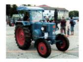
Im Jahr 1953 gab es einen neuen Schlepper bei LANZ den D2806 mit 28Ps, den D3606 mit 36Ps und später kam noch der D3206 mit 32Ps dazu. Es gab nun einen neuen Dieselmotor der die Anforderungen aus der Landwirtschaft erfüllte. Ein Hubraum von 3.7L mit Aluminiumkolben, Bosch-Einspritzpumpe, Exakt-Drehzahlregler, Pendelstarter und sehr wenig Dieselverbrauch waren die Kennzeichen des Neuen. Auch an der Lautstärke hat man etwas geändert. Der neue sehr aufwendige Auspuff
