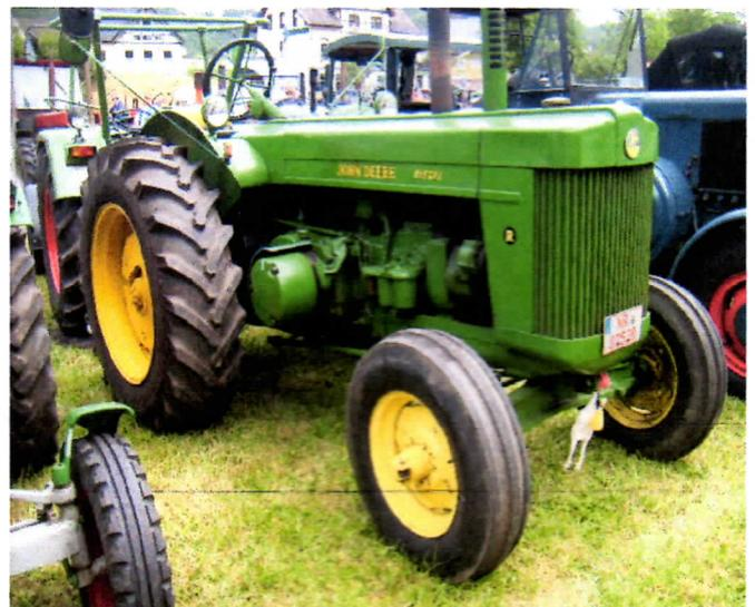
Wie man sieht, gibt es in der Eifel genau so Verrückte wie bei uns, die ihre Schlepper hegen und pflegen und bei einem Treffen zur Schau stellen. Übrigens: der John Deere ist ein US-Schlepper Bj. 1949, mit einem Startmotor, 2-Zylinder Boxer-Benzinmotor mit 410 ccm und einem liegenden 2-Zylinder-Diesel-Motor mit 6800 cm<sup>3</sup> und ca 45 PS bei 1000 U/min.
