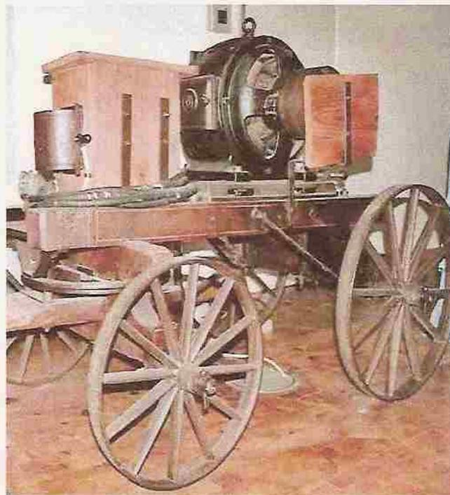
*Fahrbare Elektromotoren wie dieser Drehstrom-Schleifringläufer-Motor der Maschinenfabrik Esslingen, Baujahr 1912 mit einer Leistung von 4,2 kW erleichterte die Arbeit auf dem Hof.*
