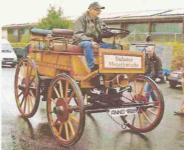
Auch ein Nachbau der „Daimler Motorkutsche“ von 1888 war auf dem Freigelände zu sehen. Die originale Kutsche wurde 1887 von der Wagenbaufirma Wimpf und Sohn in Stuttgart gebaut. Der Viertakt Motor mit unregelter Glührohrzündung, einem Hubraum von 100 ccm und einer Leistung von 2 PS bei 600 U/min wurde von Daimler/Maibach hergestellt. Der Nachbau von 2009 wurde nach original Skizzen und Zeichnungen rekonstruiert.
