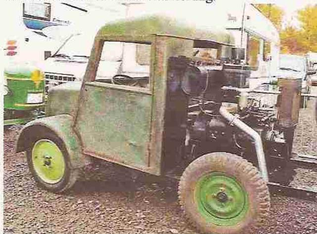
Der Junkers-Motor ist bereits instandgesetzt. Die Motorverkleidung ist abgenommen um einen freien Blick auf den interessanten Motor zu haben.
