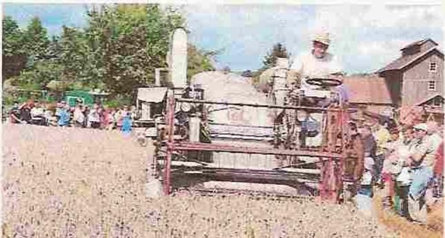
Erst mit den Selbstfahrer Mähdreschern wie diesem CLAAS Columbus mit Frontmäherwerk war das richtige Gerät entwickelt um mit wenig Personal, in kurzer Zeit die Ernte einzubringen.
