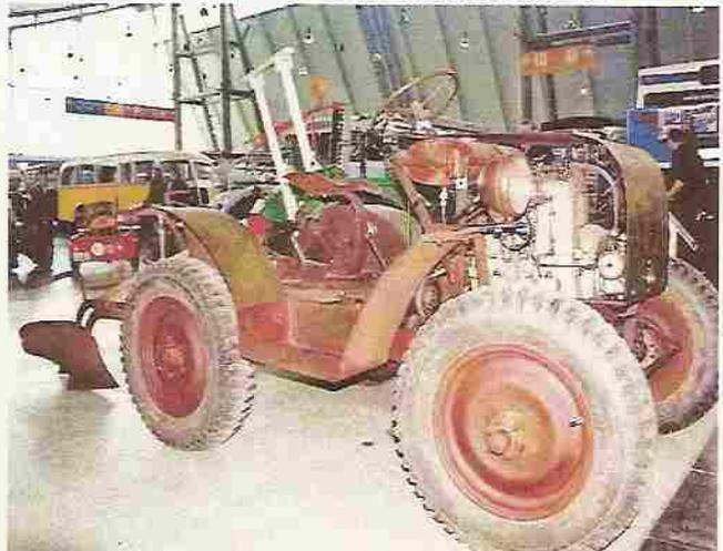
Die Motorabdeckung und die Kotflügel des Motor-Stier wurden auf einfachste Art aus Blech gebogen. Der angekoppelte Zweischar-Pflug mit Handaushebung gehörte zum Originalzubehör des Schleppers.
