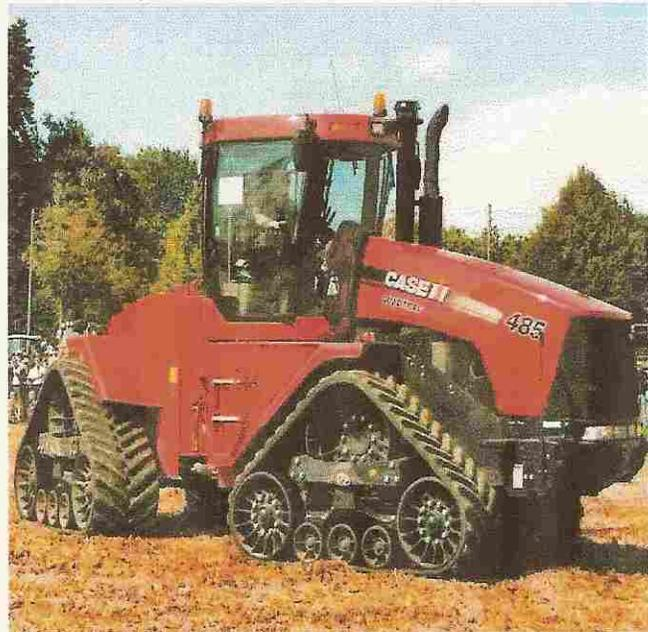
Der CASE IH QUADTRAC ist kein Oldtimer, aber trotzdem ein interessanter Schlepper, der in drei Modellen mit Leistungen von 433 bis 602 PS gebaut wird.
